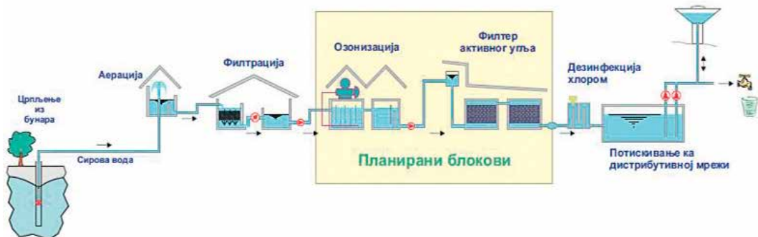
Слика 3.1.3.1. Шема технолошког процеса пречишћавања сирове воде до квалитета воде за пиће - ППВ “Шtrand”
